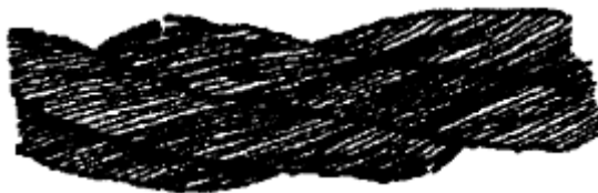
Рисунок 1. Обрывы и смещения проволок каната крестовой свивки.
