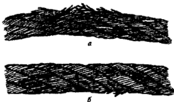
Рисунок 3. Обрывы проволок в зоне уравнительного блока:
