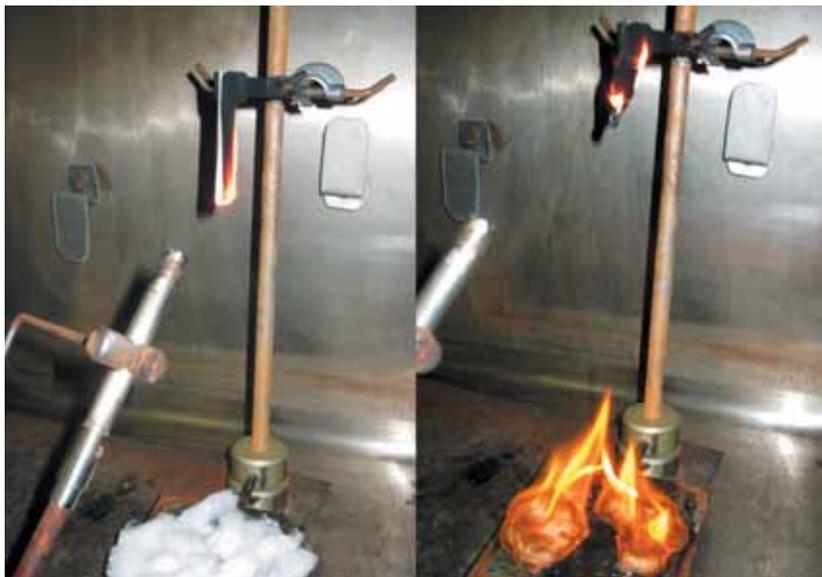
▲ Рис. 2. Испытание образца материала бака АКБ методом FV (ПВ)
