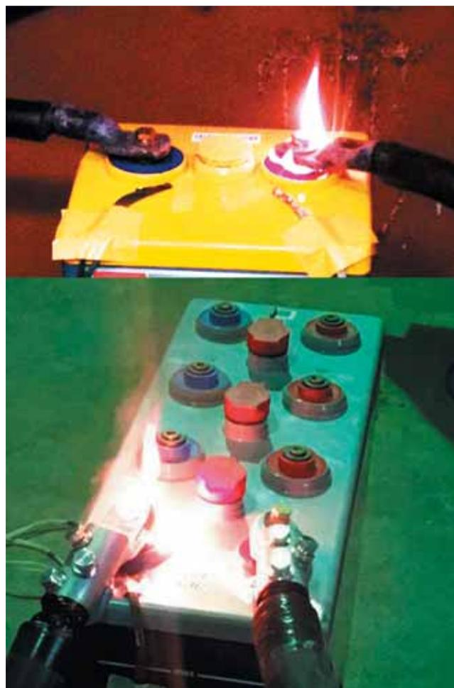
▲ Рис. 1. Открытое пламя при испытании АКБ в режиме КЗ
