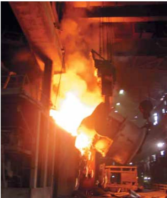
▲ Рис. 1. Заливка жидкого чугуна в конвертер
